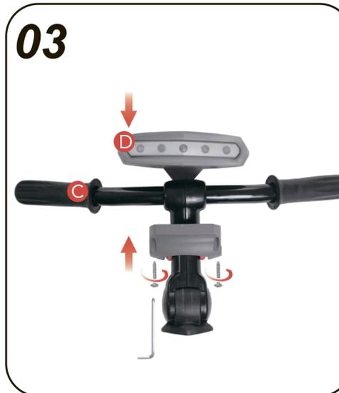
Открутите крепеж сзади фары (D), установите фару поверху руля управления (C), закрутите крепеж до упора как показано на рисунке.
