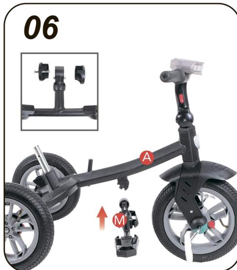
Установка подставки: открутите крепеж на подставке (M), снимите пластиковый кожух, установите подставку внизу рамы (A), затяните крепеж до упора.
