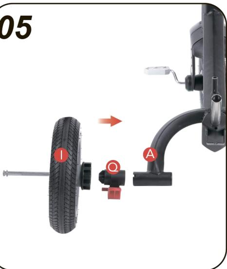
Порядок установки заднего колеса: проденьте втулку через заднее колесо (I), тормоз (Q), в раму (A) велосипеда.
