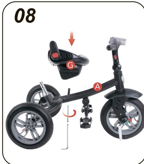
Установите сиденье (G) сверху на раму (A), снизу рамы прикрутите крепежом до упора.
